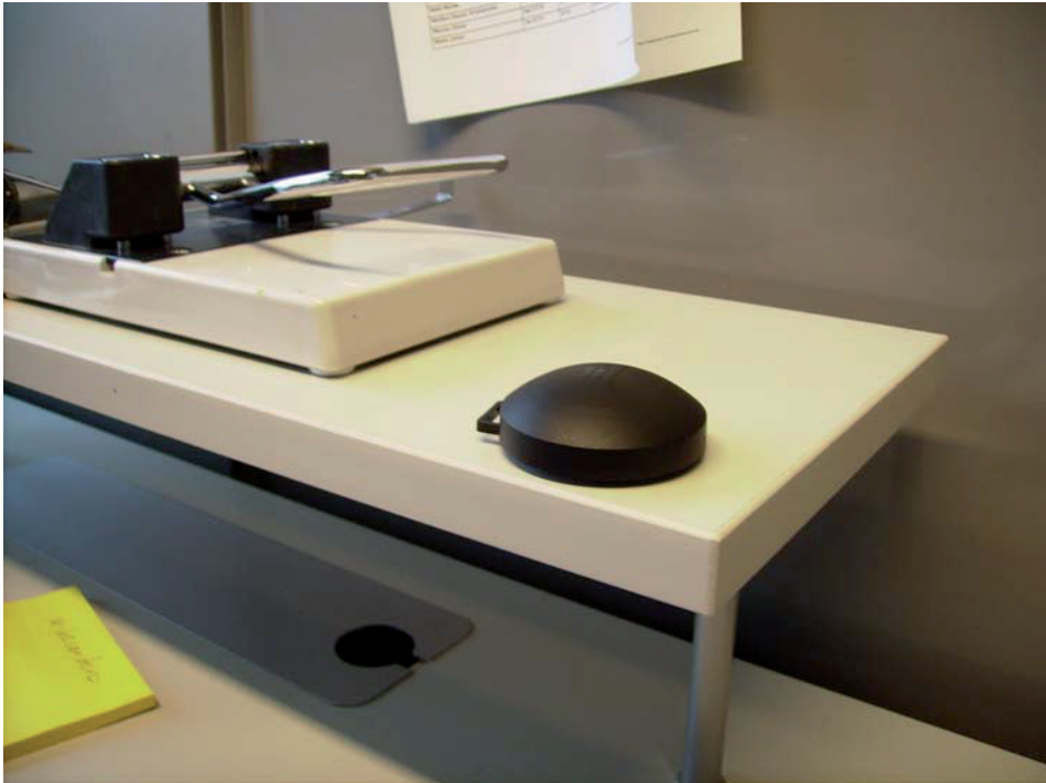
Figur 15. Radonmätning med spårfilm i kontorsbyggnad. (Foto: WSP)
