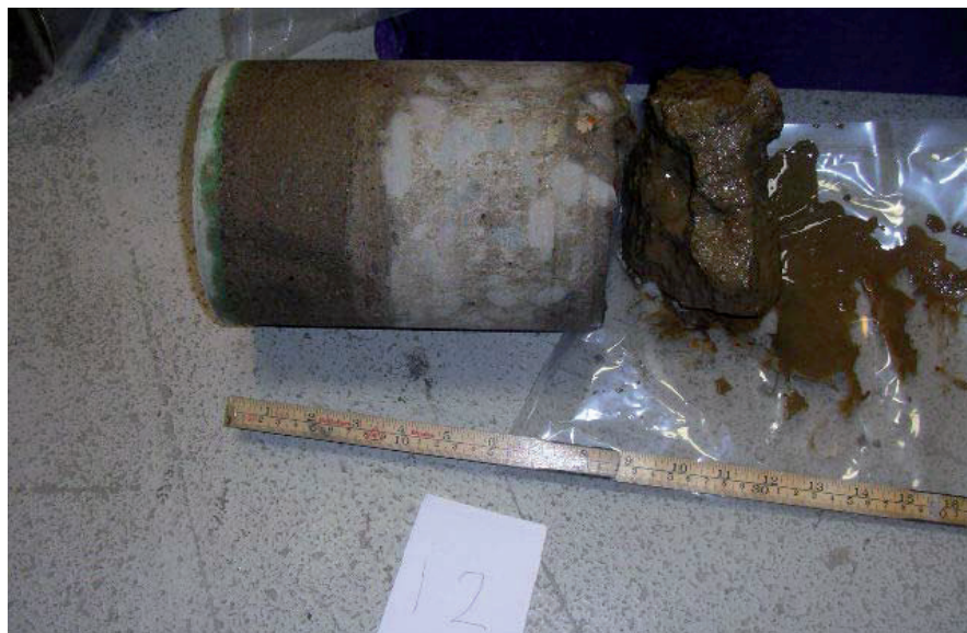
Figur 13. Stor borrkärna från betonggolvet i ett tidigare garveri, med flera olika skikt. (Foto: Golder Associates)
