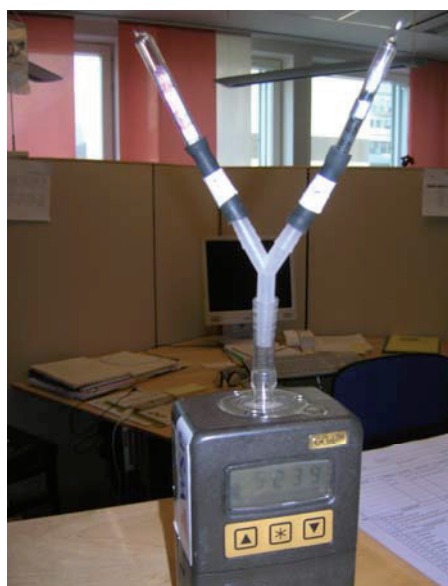
Figur 14. Aktiv pumpning med kolrör. (Foto: WSP)
