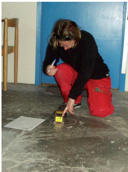
Figur 16. Mätning direkt på byggnadsmaterial med XRF-instrument, här utförd av Maud Söderberg. (Foto: Golder Associates)
